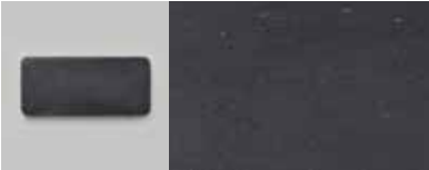
KAT10 Stuccolustro auf Schwarzputz . Die Oberfläche hat keine Textur und ist glatt. Stuccolustro noir . La surface n'a pas de texture et est lisse.
