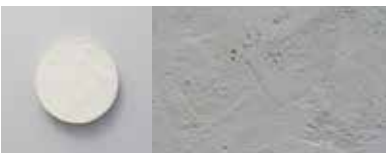
AKE01 Glatt abgekehlter Putz. Die Oberfläche hat eine gestreute Textur und ist leicht reliefiert. Crépi à la truelle lissé. La surface a une texture diffuse avec un léger relief.
