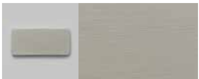
LFP13 Kalkfarbe auf Lehmfeinputz. Die Oberfläche hat keine Textur. Peinture à la chaux sur enduit à l'argile fin. La surface n'a pas de texture.
