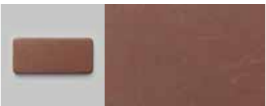
LET08 Roter Lehmputz mit Wachsüberzug. Die Oberfläche hat keine Textur. Sie hat einen mittleren Glanz. Enduit à l'argile rouge avec finition à la cire. La surface n'a pas de texture. Elle a une brillance moyenne.
