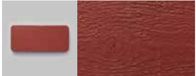
HAA09 Ölanstrich auf grundiertem Tannenholz. Die Oberfläche hat eine lineare Textur, ist leicht reliefiert. Peinture à l'huile sur bois de sapin avec couche de fond. La surface a une texture linéaire avec un léger relief.
