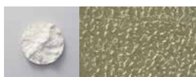
ANW11 Kellenwurf mit ausgeprägter Kraterbildung. Die Oberfläche hat eine gestreute Textur und ist sehr stark reliefiert. Enduit jeté à la truelle avec formation de cratères prononcée. La surface a une texture diffuse avec un très fort relief.
