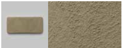
LET10 Ockriger Lehmputz Abrieb mit Lehmanstrich. Die Oberfläche hat eine gestreute Textur, ist leicht reliefiert. Crépi à l'argile ocre avec peinture à l'argile. La surface a une texture diffuse avec un léger relief.
