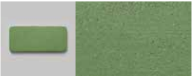
KAT13 Kalklasur auf Sumpfkalk-Feinputz. Die Oberfläche hat eine gestreute Textur. Lasure à la chaux sur enduit à la chaux grasse fin. La surface a une texture diffuse.
