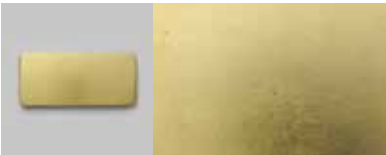
MEP02 Ölvergoldung. Die Oberfläche hat keine Textur. Sie hat einen mittleren Glanz. Dorure à l'huile. La surface n'a pas de texture. Elle a une brillance moyenne.
