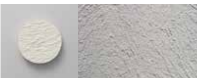
BUS02 Geschlämmter Putz gestrichen. Die Oberfläche hat eine gestreute Textur und ist leicht reliefiert. Crépi badigeonné peint. La surface a une texture diffuse avec un léger relief.
