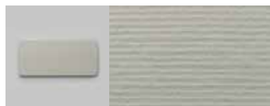
GFT07 Latexfarbe auf Glasfasertapete. Die netzförmige Textur ist leicht reliefiert. Peinture latex sur papier peint en fibre de verre. La texture réticulée a un léger relief.
