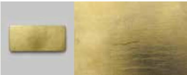
MEP03 Schlagmetallvergoldung. Die Oberfläche hat keine Textur. Sie hat einen mittleren Glanz. Dorure avec feuille de métal frappé. La surface n'a pas de texture. Elle a une brillance moyenne.
