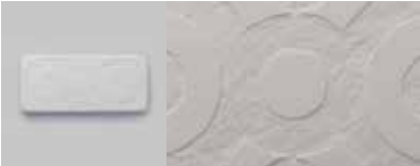
GIT03 Gipsglätte geritzt. Die Oberfläche hat eine lineare Textur und ist leicht reliefiert. Enduit au plâtre gravé. La surface a une texture linéaire avec un léger relief.
