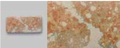
GIT06 Hydraulischer Kalkfeinputz Vollabrieb . Die Oberfläche hat eine gestreute Textur und ist glatt. Enduit fin à la chaux hydraulique ribé plein . La surface a une texture diffuse et est lisse.
