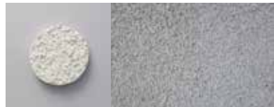
ANW01 Spritzputz mit gebrochenem Korn bis 5 mm. Die Oberfläche hat eine gestreute Textur und ist mittel reliefiert. Enduit projeté à grain concassé jusqu'à 5 mm. La surface a une texture diffuse avec un relief moyen.
