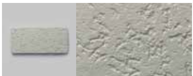
KSP07 Latexfarbe auf Kunststoffputz. Die Oberfläche hat eine gestreute Textur, ist mittel reliefiert, glänzend. Peinture au latex sur enduit synthétique. La surface est brillante avec une texture diffuse et un relief moyen.
