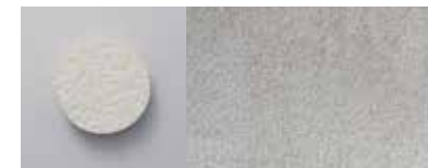
ANT03 Feinkörniger Kratzputz. Die Oberfläche hat eine gestreute Textur und ist leicht reliefiert. Crépi gratté à grain fin. La surface a une texture diffuse avec un léger relief.
